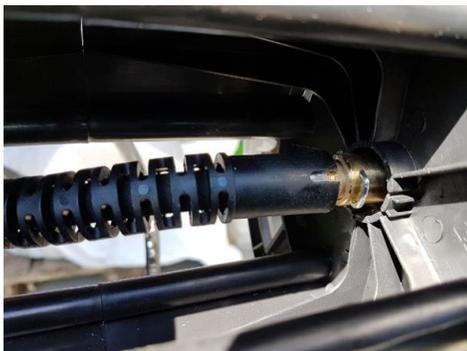
Dekk til luffehullene over motoren så du ikke mister splinten ned i maskinen.
