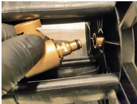
Pass på at sporene i svivelen ligger parallelt med hullene til låsebøylen.
